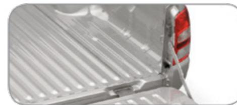
Ojačana šasija oko motora i dupli graničnik u bezbednosnom mehanizmu haube doprinoće većoj izdržljivosti i bezbednosti. U podu prtljažnika zadnji ugovi su posebno ojačani kako bi raspršili silu udarca kada se prtljac prevrne i sprečili nastanak štete kao što je pucanje bočnih panela.
